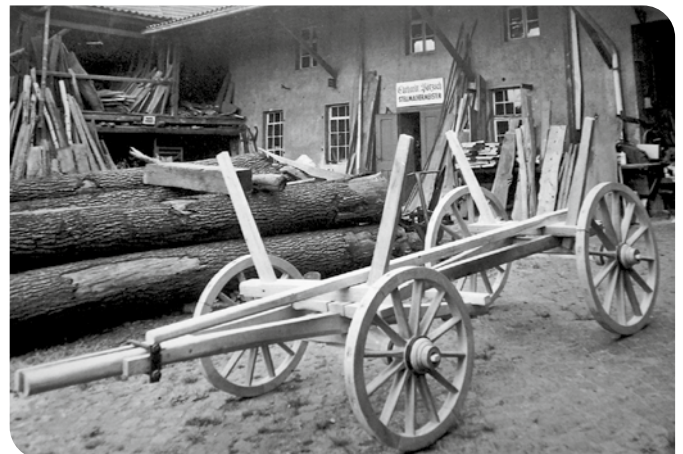
Diesen zwispännigen Ackerwagen fertigte Philip als Meisterstück an.
