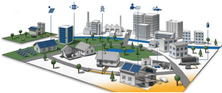
Ein intelligentes Energiesystem mit Speichern und Flexibilitäten bei Strom, Wärme und Mobilität (Grafik: DLR (CC BY-NC-ND 3.0))
